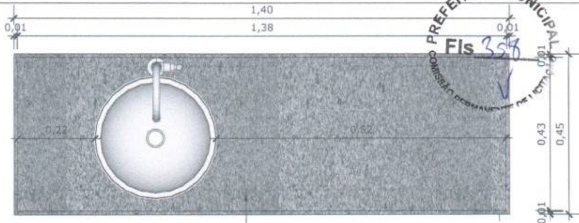
70 VISTA SUPERIOR BANCADA Escala: 1/10
