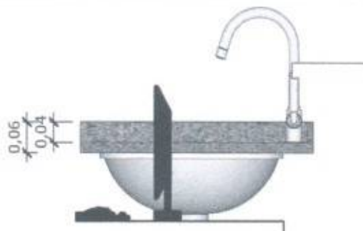
72 VISTA LATERAL BANCADA Escala: 1/10
